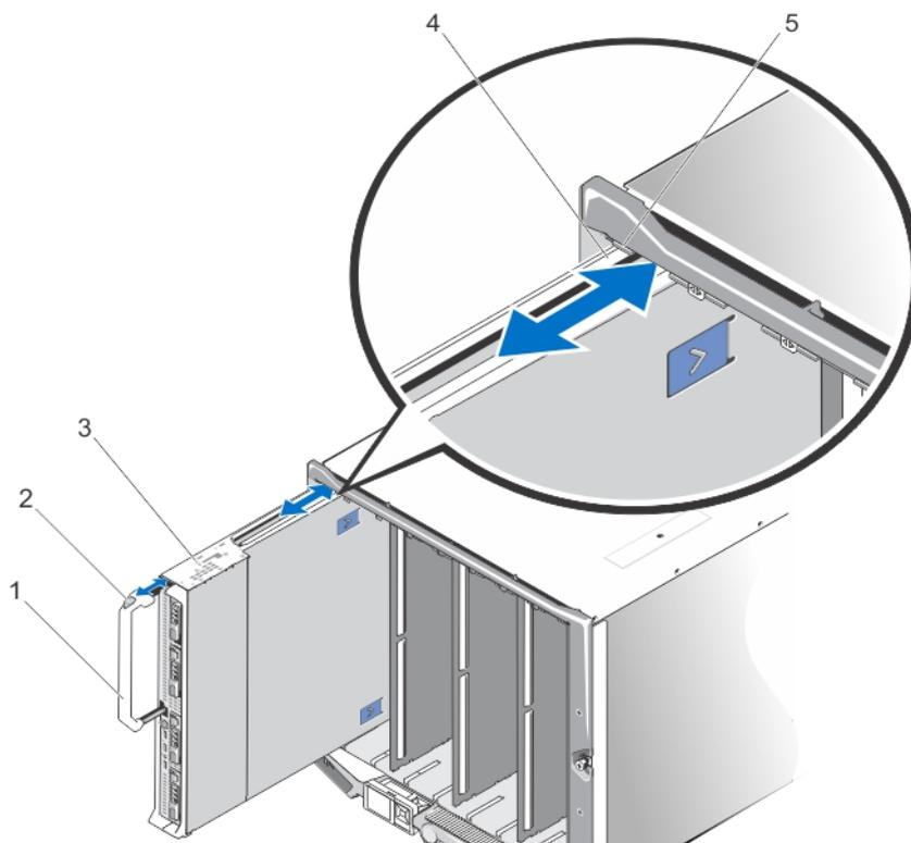
**Ilustración 3. Extracción e instalación del módulo de alta densidad**
