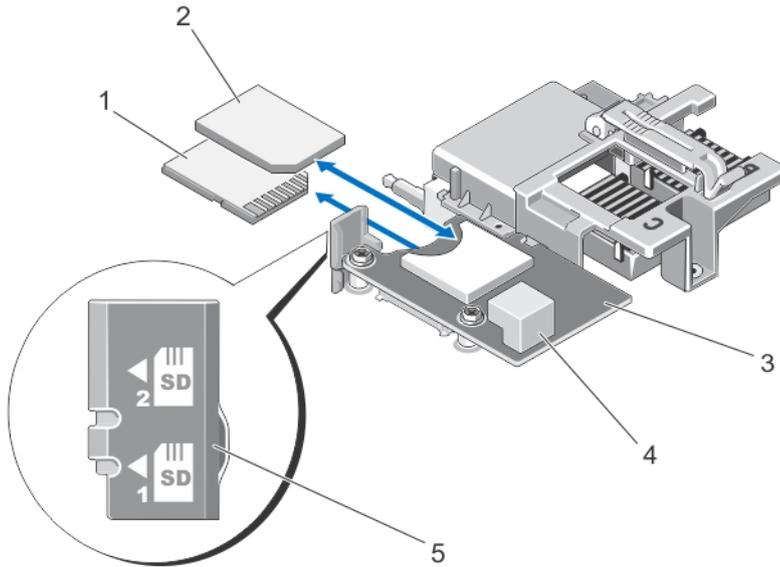
**Ilustración 13. Sustitución de la tarjeta SD**
