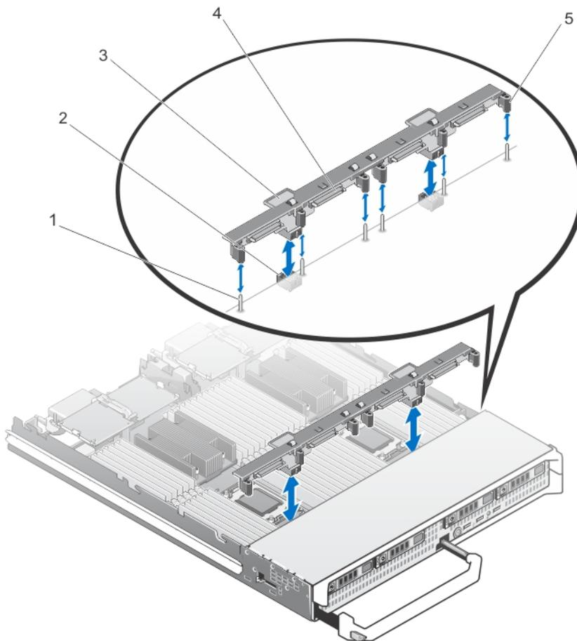
**Ilustración 9. Extracción e instalación del plano posterior de la unidad de disco duro/SSD (longitud completa)**
