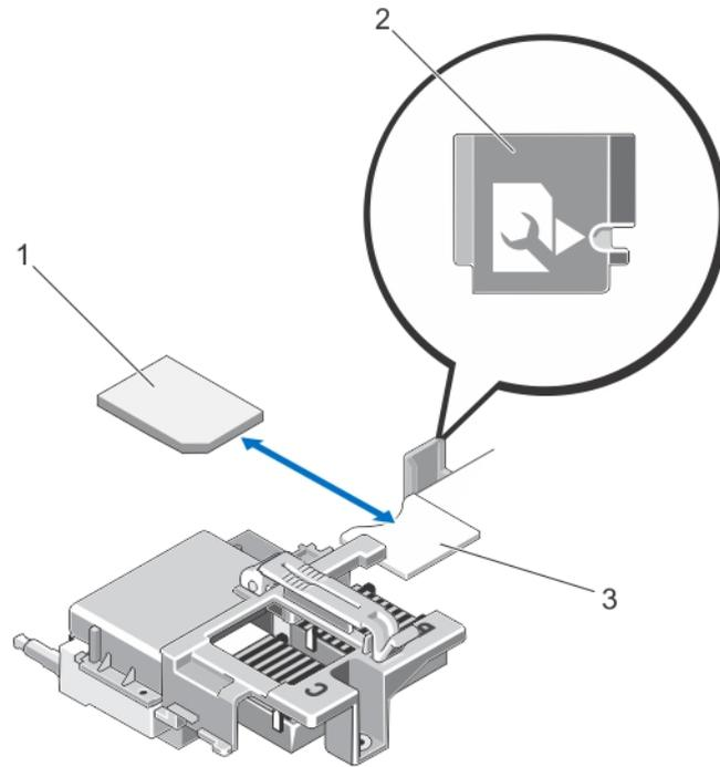
**Ilustración 15. Sustitución de la tarjeta vFlash SD**
