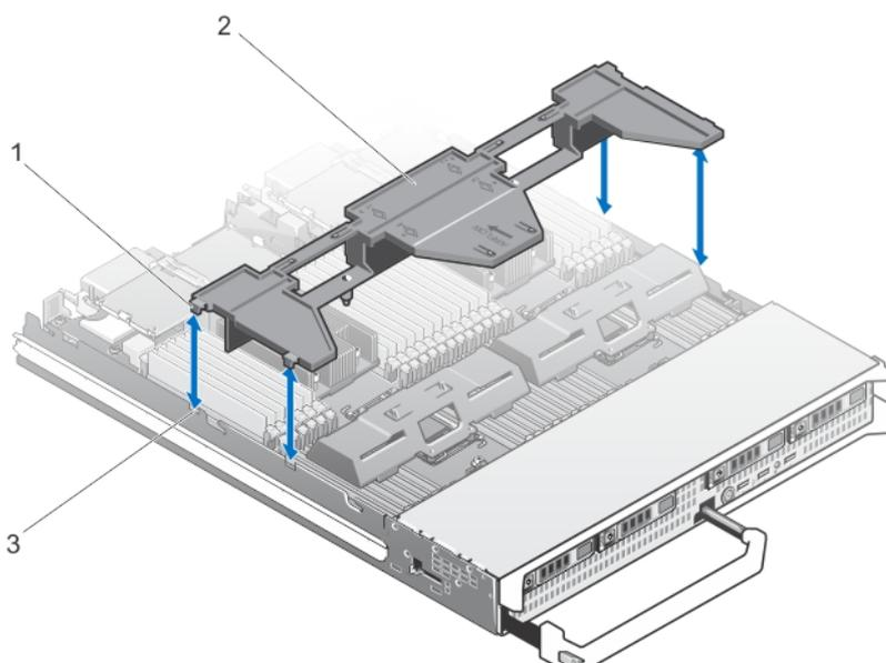
**Ilustración 6. Extracción e instalación de una cubierta de refrigeración**
