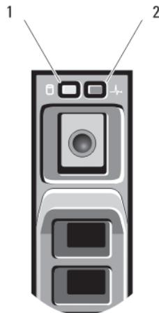
**Ilustración 2. Indicadores de la unidad de disco duro/SSD**
