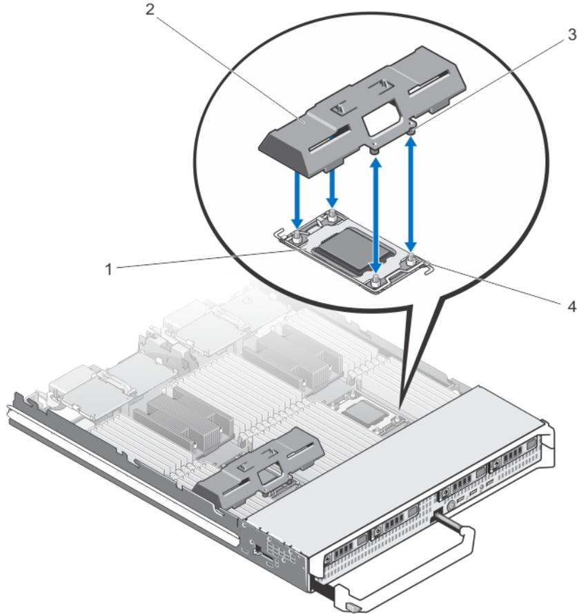
**Ilustración 16. Extracción e instalación de un procesador/módulo DIMM de relleno**
