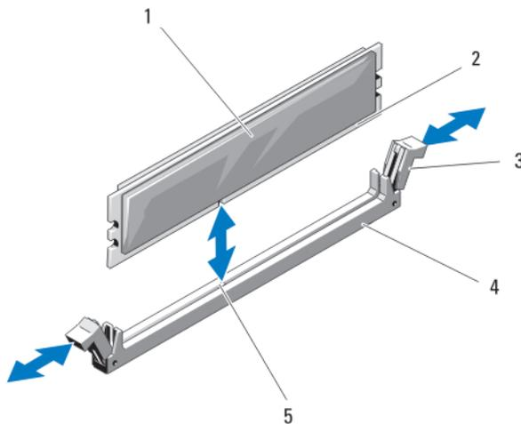
**Ilustración 22. Instalación y extracción de un módulo de memoria o un módulo de memoria de relleno**
