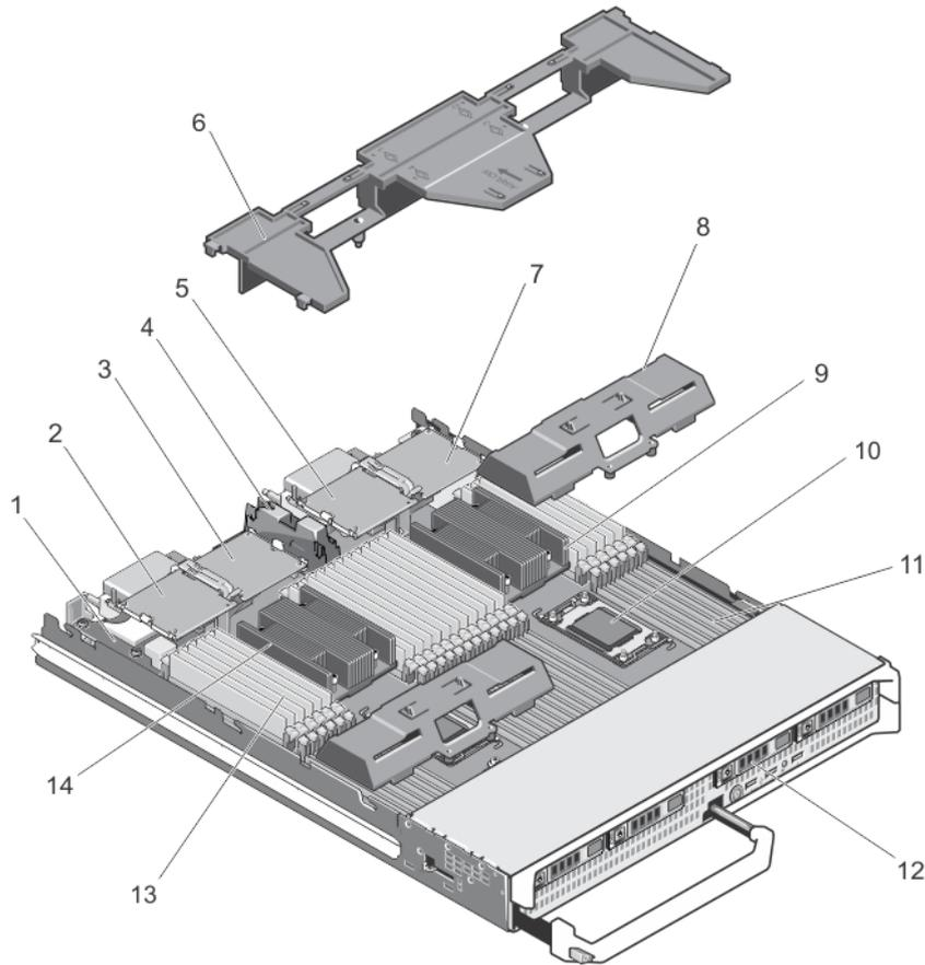
**Ilustración 5. Interior del módulo de alta densidad**
