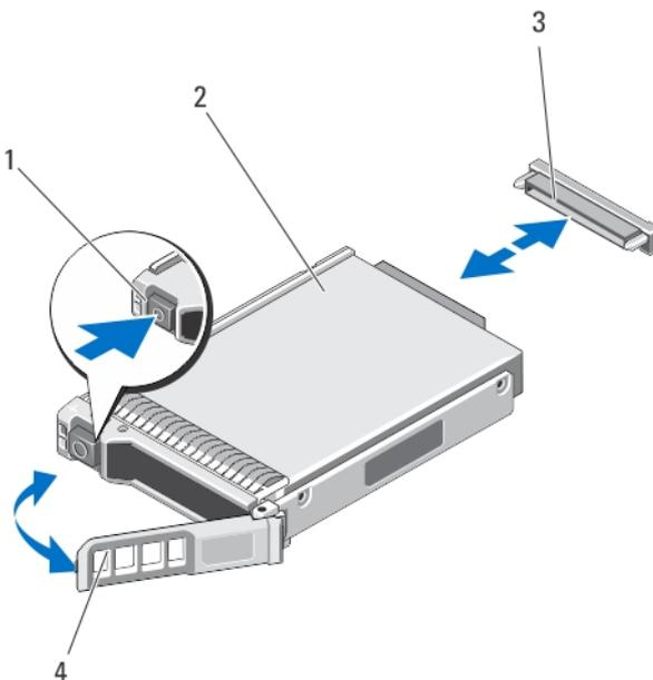
**Ilustración 7. Extracción e instalación de una unidad de disco duro/SSD PCIe**
