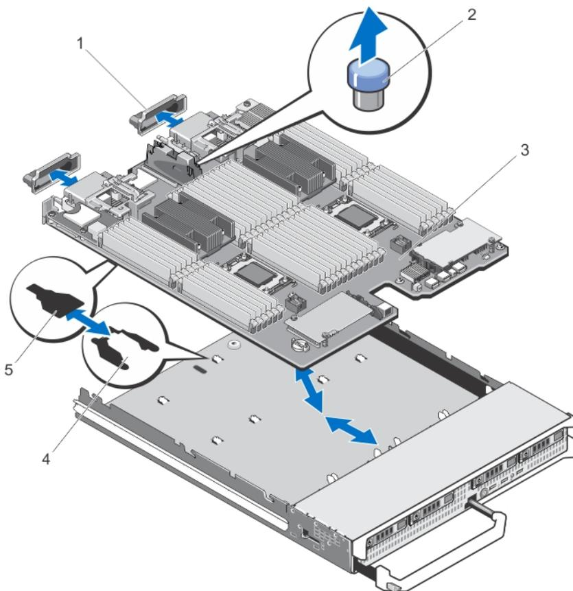
**Ilustración 20. Extracción e instalación de la placa base**
