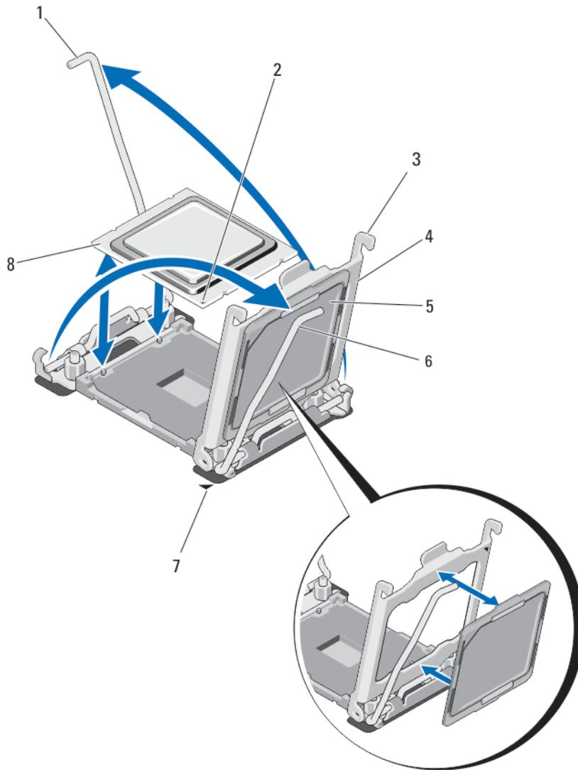
**Ilustración 19. Extracción e instalación de un procesador**
