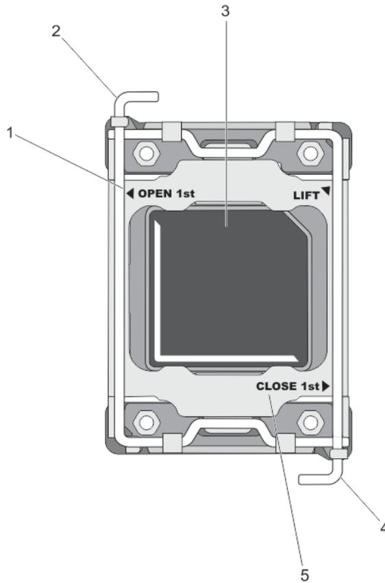
**Ilustración 18. Secuencia de apertura y cierre de la palanca del protector del procesador**
