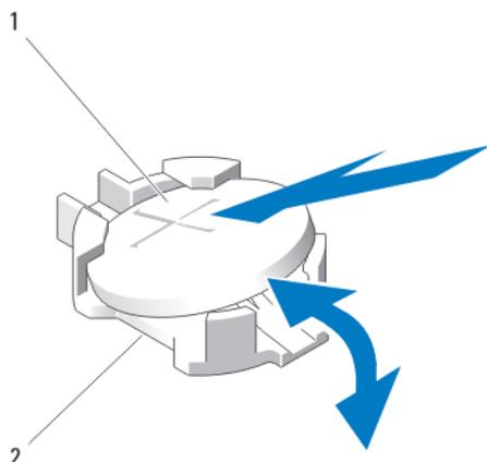
**Ilustración 23. Sustitución de la pila de reserva de la NVRAM**
