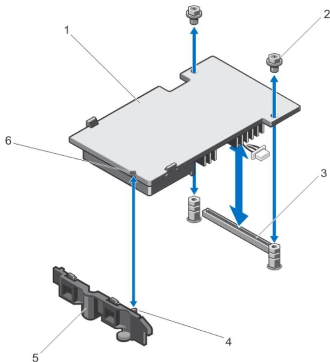
**Ilustración 25. Extracción e instalación de una tarjeta extendida PCIe**
