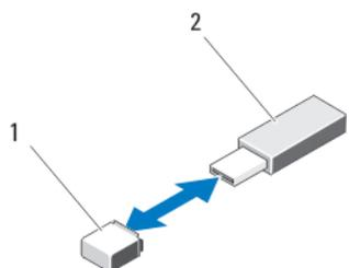
Ilustración 14. Sustitución de la memoria USB
