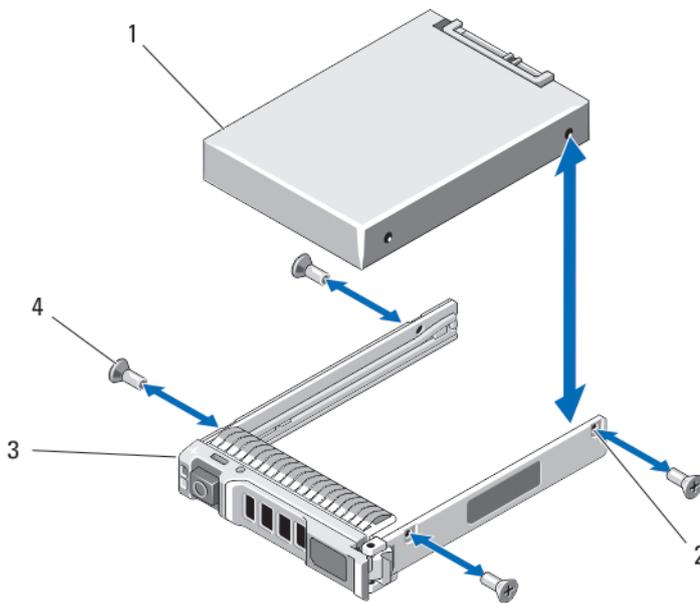
**Ilustración 8. Extracción e instalación de una unidad de disco duro/SSD PCIe en un portaunidades de unidad de disco duro/SSD PCIe**
