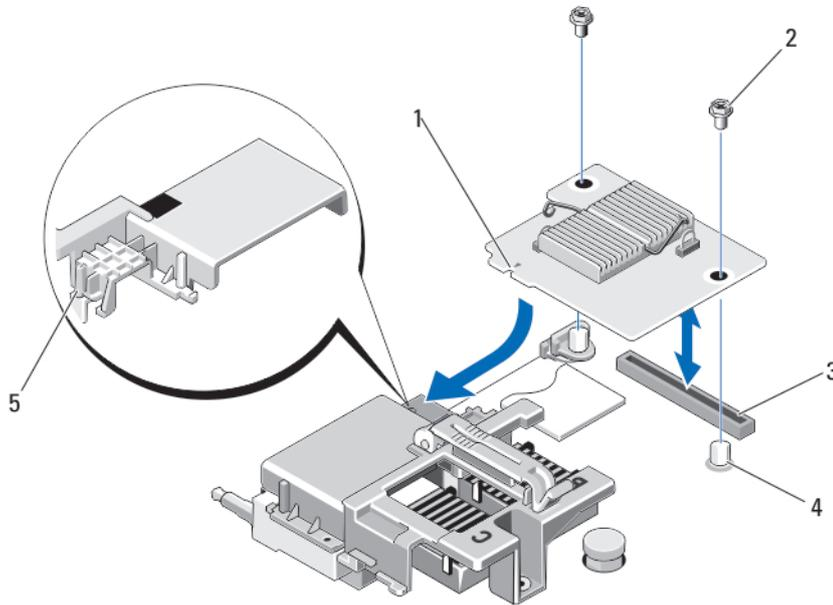
**Ilustración 12. Extracción e instalación de la tarjeta de red secundaria/tarjeta vertical de LOM**
