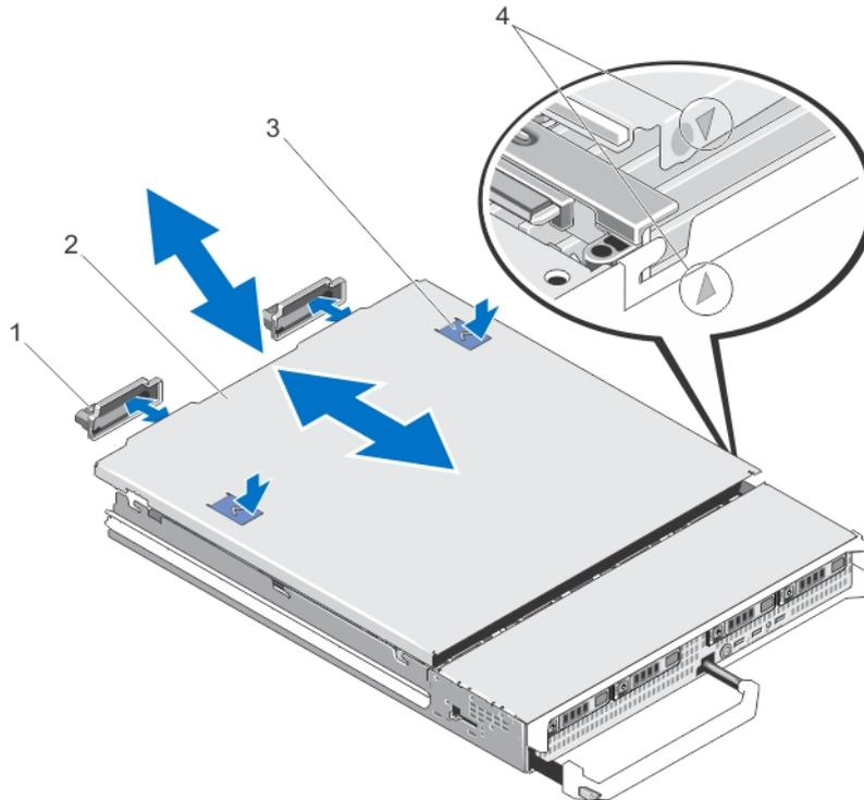
**Ilustración 4. Apertura y cierre del módulo de alta densidad**
