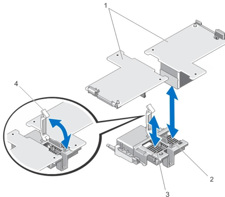
**Ilustración 11. Extracción e instalación de una tarjeta intermedia**
