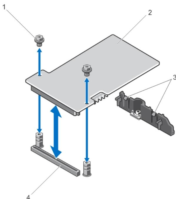
**Ilustración 24. Extracción y colocación de una tarjeta controladora de almacenamiento**
