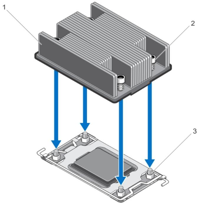
**Ilustración 17. Extracción e instalación de un disipador de calor**
